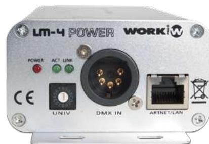
Panel frontal de LM 4 con su conexionado LAN, selector de grupo y LEDs testigo de señal DMX y Ethernet.
