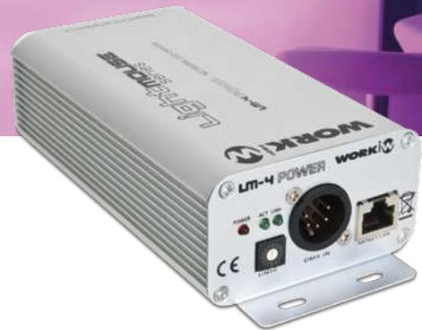
Las ventajas de combinar ambos elementos en una única unidad son evidentes, al permitir realizar todo de instalaciones de control LED RGB, ya sea desde la más sencilla: consistente en una consola de control DMX conectada a la entrada de LM 4 Power, hasta instalaciones de sistemas de control integrados en una red Ethernet consistentes en múltiples universos DMX.
