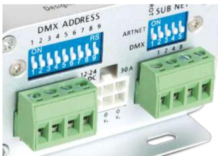
2 salidas RGB (total 15A). Dip Switch para selección de dirección DMX o selección de máscara de red según el modo de funcionamiento (DMX o ArtNet).
