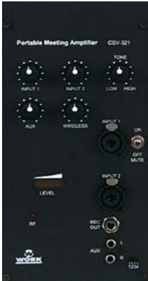
Entrada AUX con 4 posiciones de selección de atenuación.
