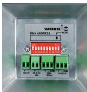
IC 6 PRO A. Conexionado y selección de canal DMX.
