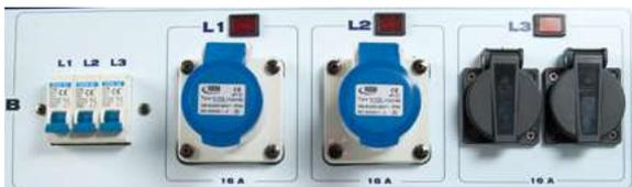
2 bloques de salidas con 2 conectores monofásicos (1P+N+E) y 2 schukos de 16 A cada uno y magnetotérmicos de protección individuales. Neón testigo de presencia de cada fase.
