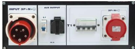
Conexión de entrada trifásica (3P+N+E) de 63 A. 2 salidas adicionales (trifásica 3P+N+E de 32 A y monofásica Schuko de 16 A), ambas salidas protegidas.
