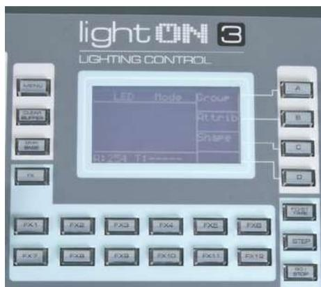
Pantalla LCD de 60 x 128 puntos. Pulsadores retroiluminados con cambio de color según estado y función. Canales preasignados para control de dispositivos LED (RGBA) y control para Movie Lights (PAN/TILT, etc).
