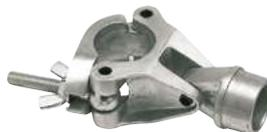
Abrazadera simple con tornillo para tubo de 48-50 mm. Inserción hembra y sistema de rótula. Carga máx. 500 kg.
