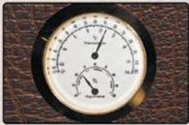
Medidor de humedad y temperatura.
