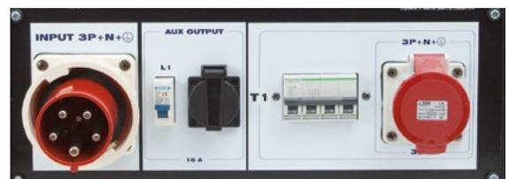
Conexión de entrada trifásica (3P+N+E) de 63 A, 2 salidas adicionales (trifásica 3P+N+E de 32 A y monofásica Schuko de 16 A), ambas salidas protegidas.
