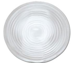
Este tipo de lente se asemeja a una lente plano-convexo con delgados y aplanados círculos concéntricos. Estos círculos están situados en la parte convexa para evitar sobretemperatura y reducir peso. Los surcos así producidos en la superficie, permiten enfocar la luz y obtener una mayor dispersión lumínica.
