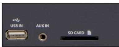
Conexiones externas adicionales: Puerto USB, entrada auxiliar y Slot para tarjeta SD.
