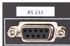
Conexión RS 232 para control externo de funciones.
