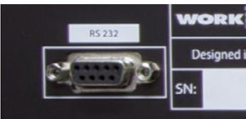
Conexión RS 232 para control externo de funciones.
