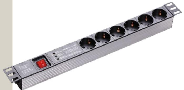
Base de conexión con perfil de aluminio de 1 unidad de rack de 19", con 6 conectores base schuko hembras mas sistema de protección de con 3 leds de indicación.
