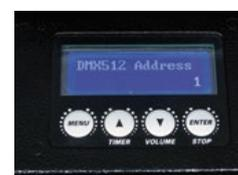
Este ventilador controlado mediante señal DMX o mando inalámbrico, es un elemento indispensable en instalaciones que incorporen máquinas de humo, al permitir dispersar el humo generado y cubrir una amplia zona de manera rápida y homogénea. La velocidad de giro del ventilador es dimmerizable entre 1 y 100% y su diseño permite colocarlo en el suelo o boca abajo sujeto a estructuras.
