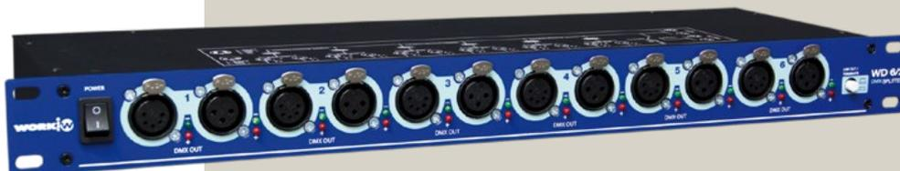
El WD 6/2 Splitter es un distribuidor de 6 vías con conectores de entrada XLR de 3 y 5 pines. Esta unidad toma la señal entrante y la distribuye en seis canales de salida separados. Cada entrada y salida están completa y electrónicamente aislada del resto, todos los canales de salida, disponen de driver de salida independiente para incrementar la señal DMX. Además un selector Link out/Terminate, se usa para asegurar la conexión y cerrar el bucle de la señal DMX.
