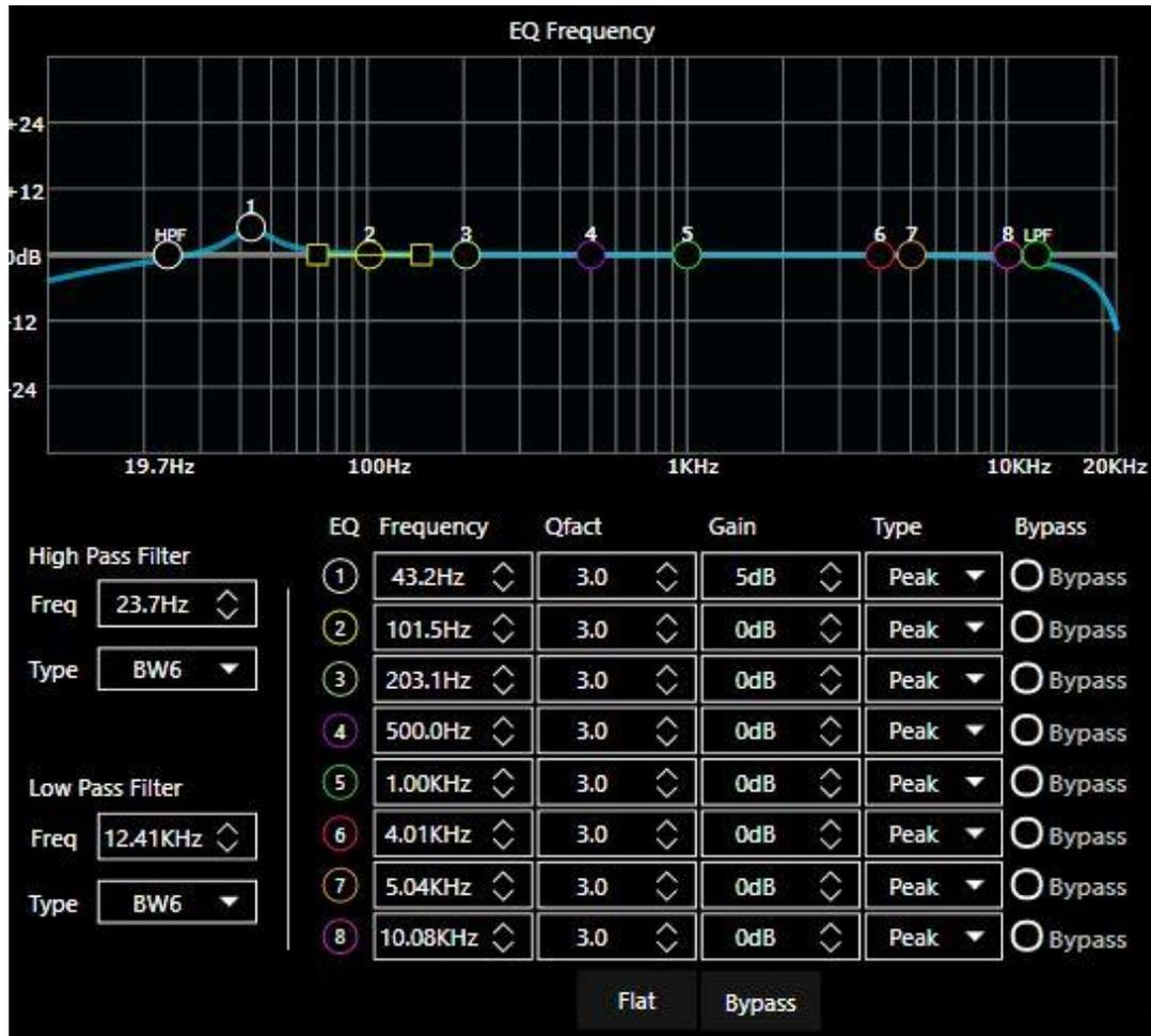
La curva resultante de la aplicación de estos filtros se muestra en la parte superior.
