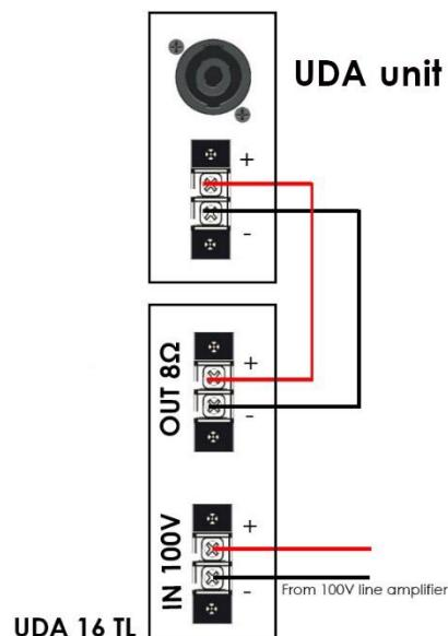
NOTA: Para una mejor compresión del dibujo, recuerde, UDA 8 y UDA 16 incorporan conector Speakon y bloque de terminales, y UDA 1, UDA 2 y UDA 4 sólo bloque de terminales.
