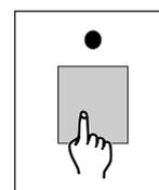
Mueva el potenciómetro de velocidad para ajustar el valor buscado
