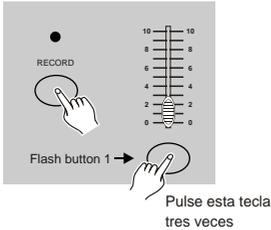
1. Pulse la tecla Flash 1 tres veces mientras mantiene pulsado la tecla Record, la pantalla muestra "CHI" indicando que la configuración de canal MIDI IN está disponible.
