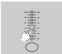
5. Mueva el fader de canal para ajustar la salida del programa actual.
