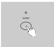
5. Para volver al modo normal, pulse la tecla Audio una segunda vez, lo que causará que su LED se apague y se desconecte el modo Audio.
