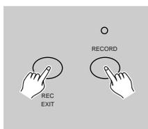
8. Puede seguir programando o salir. Para salir del modo Program, pulse la tecla Exit mientras mantiene la tecla record, el LED Record debería apagarse.
