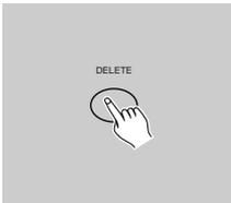
3. Pulse la tecla Delete cuando haya localizado el paso que desea borrar, todos los LEDs parpadearán para indicar que ha eliminado el paso.
