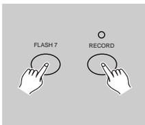
2. Presione la tecla Flash 7 tres veces mientras mantiene pulsado el botón Record, lo que permite borrar todas las configuraciones de canal y dejar la configuración predeterminada p.e. Los canales 1-48 secuencialmente.
