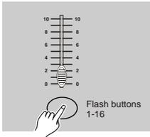
2. Pulse la tecla de Flash numerada del 1-16 para asignar el canal MIDI OUT entre 1-16, el LED del canal relevante se ilumina, indicando que el canal MIDI OUT está configurado.
