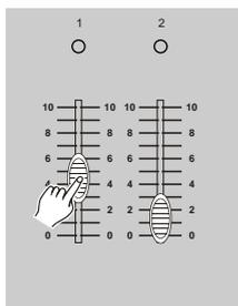
3. Cree la escena usando los potenciómetros de canal 1-48 . Al 0% o DMX 0, estos potenciómetros están en su posición mínima y al 100% o DMX 255, estos potenciómetros deben estar al máximo.
