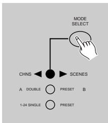
1. Pulse la tecla Mode Select para seleccionar el modo CHNS ◀▶ SCENE indicado por el LED rojo.
