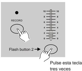
1. Pulse la tecla Flash 2 tres veces mientras mantiene pulsado la tecla Record, la pantalla muestra "CHO" indicando que la configuración del canal MIDI OUT está disponible.
