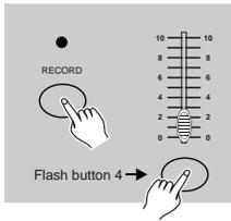
Pulse la tecla Flash 4 tres veces mientras mantiene pulsada la tecla Record, la pantalla muestra "OUT" indicando que el controlador está preparado para enviar un fichero MIDI
