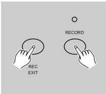
Presione y mantenga la tecla Record. Mientras pulse la tecla Rec Exit para salir de la configuración MIDI.
