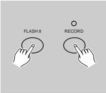
2. Pulsando la tecla Flash 8 tres veces mientras mantiene la tecla Record, le permite acceder a la configuración de canal DMX. La pantalla lee el canal DMX actual.
