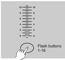
2. Pulse la tecla de Flash numerada del 1-16 para asignar el canal MIDI IN entre 1-16, el LED del canal relevante se ilumina, indicando que el canal MIDI IN está configurado.
