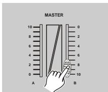
3. Mueva el fader Master B a su posición máxima (totalmente arriba)
