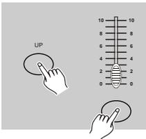
4. Mientras mantiene pulsado las teclas Up o Down, pulse la tecla Flash correspondiente al canal DMX de la escena que desea modificar hasta conseguir el valor de intensidad deseado en la pantalla. Entonces pulse los botones Flash hasta que esté satisfecho con la nueva escena.
