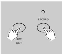
5. Pulse la tecla Rec Exit mientras presiona y mantiene la tecla Record, el LED SCENE se apaga, indicando la salida del modo Edit.
