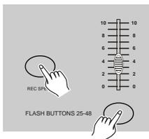
5. Mientras presione y mantiene la tecla Rec Speed pulse el botón de Flash 25-48 para almacenar el programa
