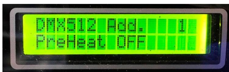
Presione MENÚ para seleccionar el modo DMX y configurar el canal de inicio DMX. En este modo, el control remoto no funciona.
