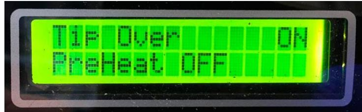
En la posición ON (predeterminada y recomendada), el dispositivo deja de funcionar si se volteea.
