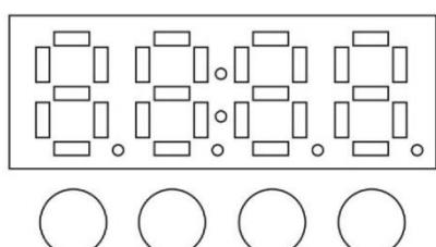
Presione el botón MENU (una o varias veces) hasta llegar a la función deseada (según el siguiente cuadro), y presione ENTER para confirmar su selección. Utilice los botones UP y DOWN para navegar entre cada función para seleccionar el valor correcto. (Pulse ENTER para confirmar la configuración).
