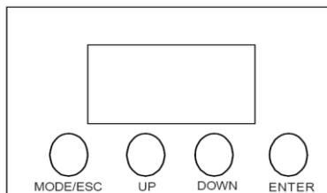
Al menú principal se accede pulsando el botón MODE / ESC , navegue por el submenú pulsando las teclas Up y Down. Presione la tecla Enter para seleccionar el menú deseado. Puede cambiar la selección pulsando Up o Down, confirmar cada selección pulsando la tecla Enter. Para salir de cada modo seleccionado pulse la tecla Esc. Las funciones proporcionadas se describen en el siguiente ajuste.
