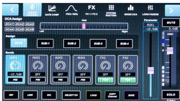
En esta pantalla, se debe pulsar sobre el envío al auxiliar 1. Una vez está seleccionado en color azul, se debe ir incrementando mediante el encoder global de ajuste [Sección 8] el nivel de envío del canal al auxiliar 1. Puesto que por defecto los buses de la mesa de mezclas tienen los niveles a 0 dB's conforme se va incrementando el nivel se debería de escuchar el micrófono por el monitor.
