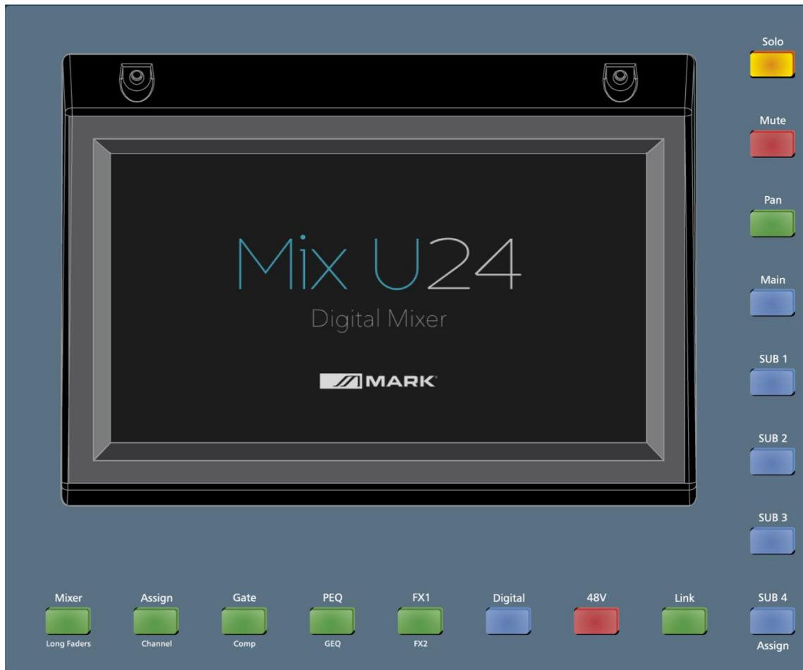
Esta sección de la mesa de mezclas permite al operador controlar todos los parámetros del procesado de audio. Esta sección se complementa con la sección de control principal [sección 8], que cuenta con todos los botones necesarios para controlar los parámetros que en la mesa se visualizan.
