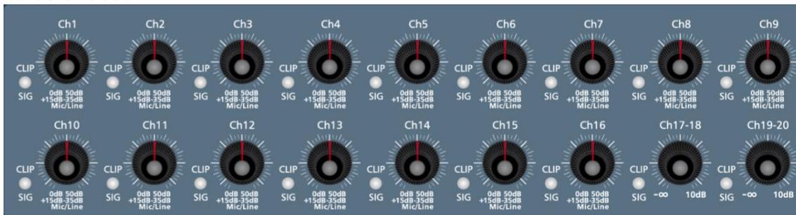
Los potenciómetros de control de ganancias de entrada sirven para realizar el ajuste de ganancia de entrada para obtener un nivel de señal adecuado para la mezcla. Al lado de cada potenciómetro hay un led bicolor verde/rojo. El led verde indica la presencia de señal y rojo indica que se ha sobrepasado el límite, por lo que habrá distorsión. Por lo tanto, en presencia de un canal con un indicador en rojo lo adecuado será reducir la ganancia de entrada mediante el potenciómetro de dicho canal.
