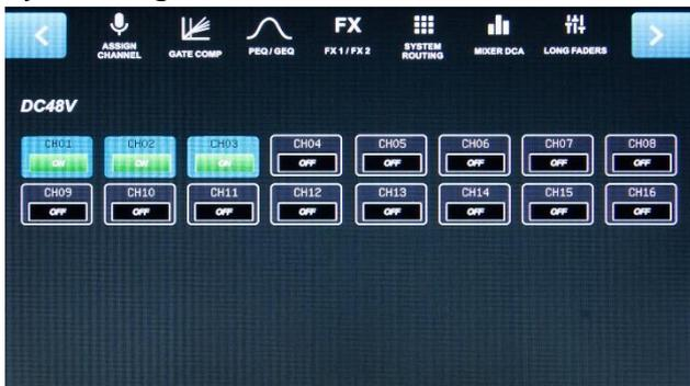
Primero de todo, hay que conectar las alimentaciones phantom, ya que se trata de micrófonos de tipo condensador y necesitan alimentación para funcionar. Para ello presionaremos el botón 48V [Sección 3] y en la pantalla seleccionaremos y confirmaremos a qué canales de entrada queremos aplicar alimentación phantom. La pantalla siguiente muestra como deben quedar ajustadas las alimentaciones phantom de los 3 primeros canales.
