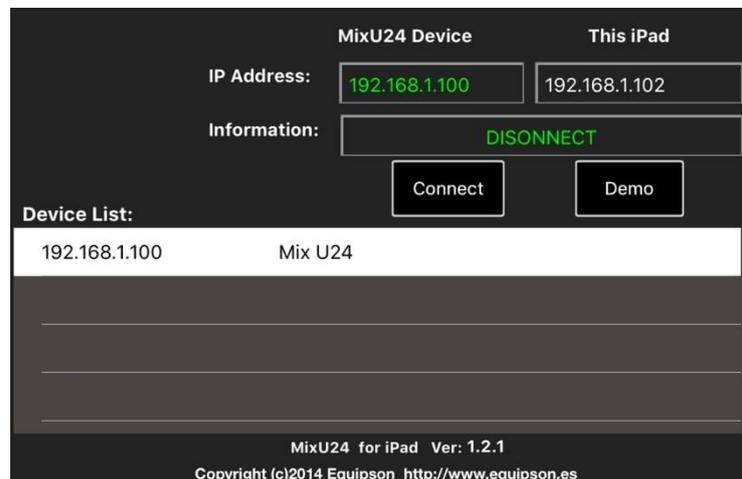
Una vez ambos dispositivos estén enlazados correctamente desde la pantalla del iPad se mostrará la misma información que en la pantalla de la propia MIX U24, pudiendo así controlarla de manera remota, tales funciones como el fader de cada canal, la ecualización, efectos, compresión etc.
