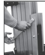
Gire la manivela de cada pata estabilizadora hasta que las ruedas localizadas en la base toquen el suelo.
