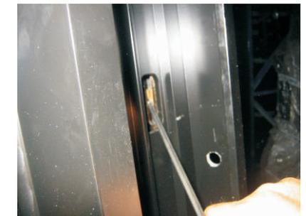
Utilizar una llave Allen o similar para proceder a la liberación del sistema de seguridad y desbloquear el tramo
