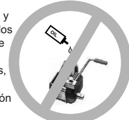
No lubrique el sistema de frenado del cabestrante, el mecanismo podría perder efectividad.
