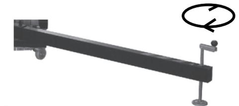
Para extraer las patas, tire del pasador correspondiente y extraiga la pata.
