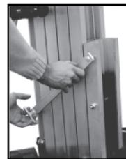
Para una mayor seguridad durante el transporte, estas torres incorporan un sistema de fijación de los perfiles que impide el movimiento de los mismos. Para ello debe liberar el mecanismo actuando sobre el muelle y la pieza alojada en el agujero de fijación.
