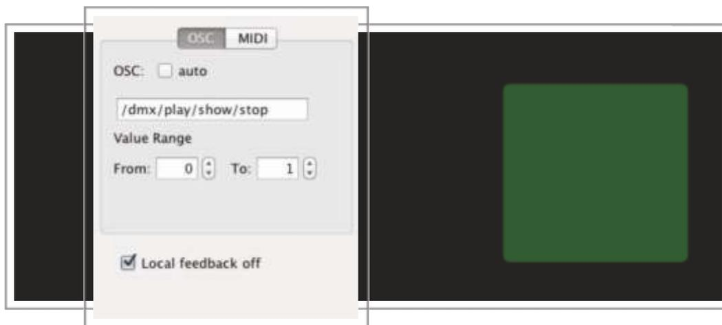
El comando introducido permite detener el show ejecutado tanto en modo automático como en modo manual a través de un push button.
