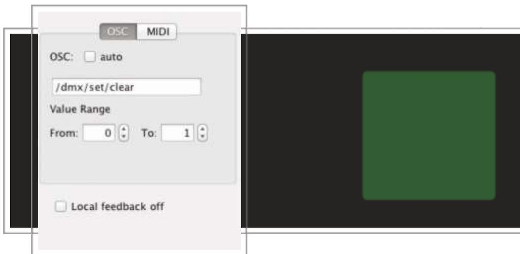
El comando introducido permite poner todos los canales de DMX a 0 a través de un Push Button.
