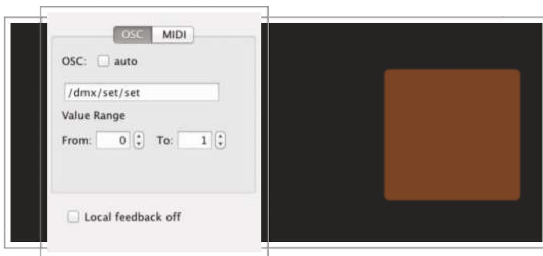
El comando introducido permite poner todos los canales de DMX a 255 a través de un Push Button.
