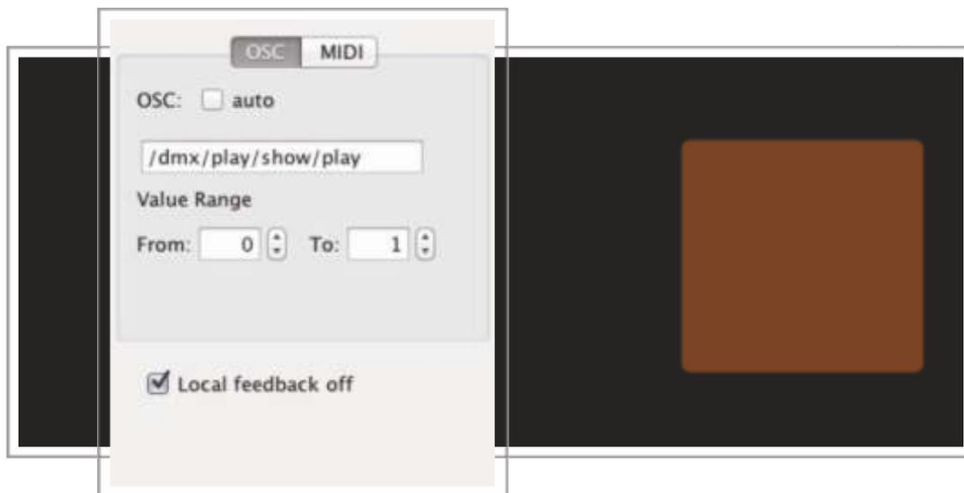
El comando introducido permite ejecutar un show previamente seleccionado en el MultiToggle anteriormente visto. Este modo de ejecución reproduce todas las escenas que conforman el show una tras otra según el orden en que fueron grabadas y con los tiempos de espera y fundido almacenados
