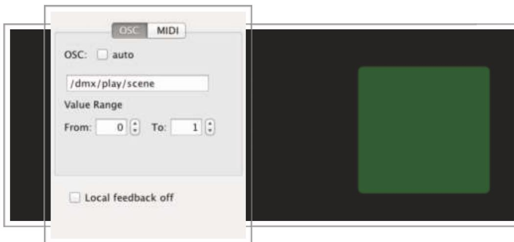
El comando introducido permite ejecutar una escena previamente seleccionada en el MultiToggle anteriormente visto.
