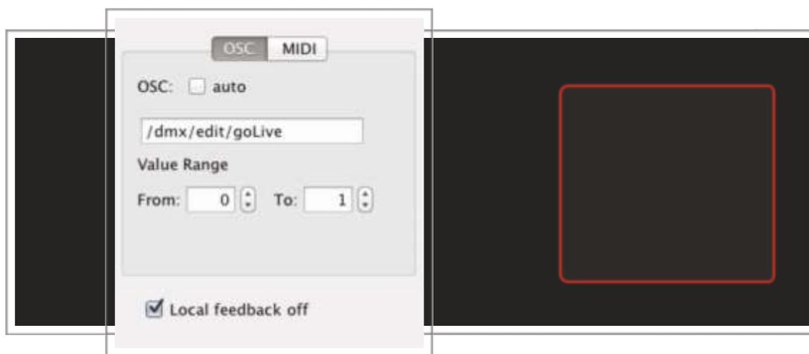
El comando introducido permite mostrar los cambios realizados en la programación a tiempo real a través de un Toggle, permitiendo activarlo o desactivarlo.
