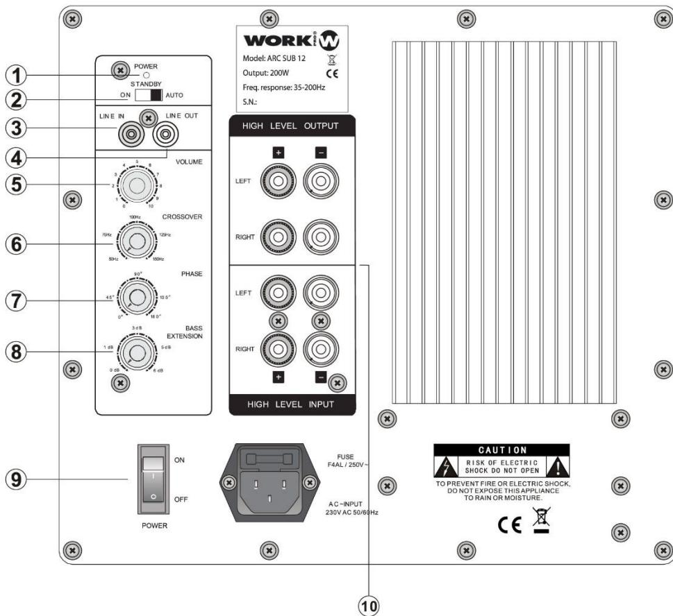
**1. Indicador de encendido:** Se ilumina cuando el subwoofer está encendido.
