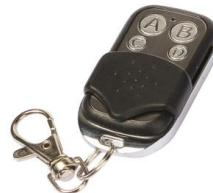
Cuando la unidad se enciende y el sistema inalámbrico está activado, la pantalla muestra "wireless setup". En ese caso, el usuario puede registrar el mando presionando cualquier botón durante 1 segundo. Si la pantalla parpadea 2 veces, entonces ambas unidades están conectadas. Un mando puede controlar hasta 5 unidades. Si intenta registrar una sexta unidad, la primera unidad almacenada se borra.
