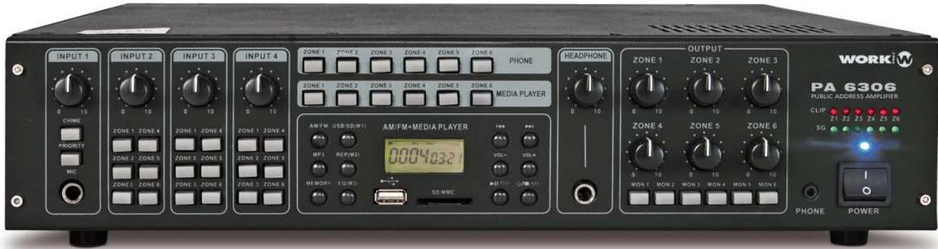
Amplificador de 6 entradas y 6 zonas de salida que permite crear una matriz de 6x6 al permitir el envío de cualquiera de las entradas a cualquiera de las salidas. Cada entrada tiene sus propios controles de volumen y selección de salida para su envío mediante conmutadores. De esta manera, las entradas pueden sumarse en la salida requerida.
