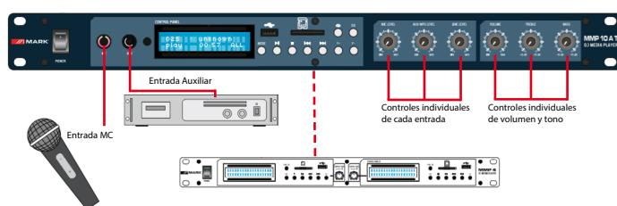
• Ejemplo de conexión aprovechando las entradas MIC, AUX y LINE además de los puertos externos USB y SD.
