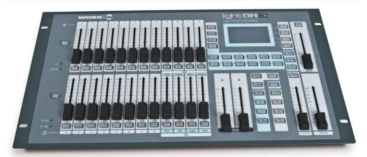
LightON 3 es una consola de 512 canales DMX para el control tanto de iluminación convencional, Moving Light y LEDs.
