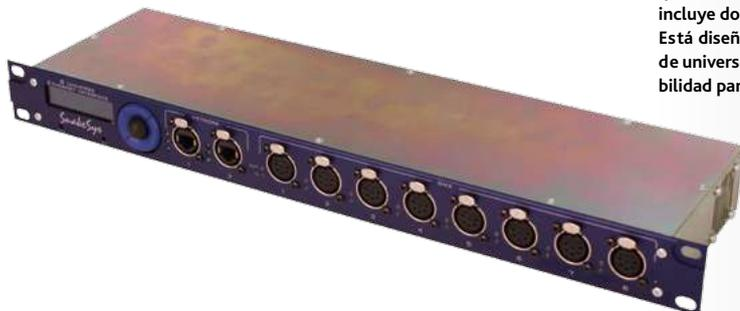
Usa un simple pero potente motor de conversión Ethernet a DMX, basado en una FPGA customizada lo que asegura un rendimiento y fiabilidad óptimos. Está realmente diseñado para realizar esa función específica. De este modo se evitan diseños complejos y de bajo rendimiento basados en hardware PC o placas de microprocesador. El procesado DMX es manejado directamente por la lógica de la FPGA.
