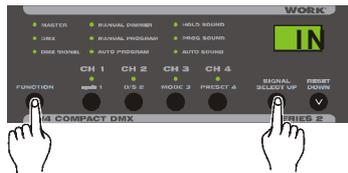
Presione y mantenga pulsado el boton F, pulse la tecla de selector de señal, esto hara que el display muestre "IN", el LED DMX se iluminara indicando que el modo DMX esta activo, la unidad sirve como un dimmer DMX de 4 canales.
