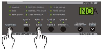
La pantalla muestra "NOR" cuando el dimmer normal esta activado, en modo Normal, el nivel de salida varia de acuerdo al control manual.
