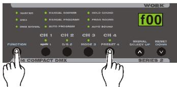
Mantenga pulsado el botn F, pulse el boton Preset varias veces para cambiar las funciones entre Fade Time/Dimmer/Spree/Program.
