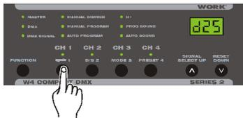
1. Cuando el modo Dimmer Manual esta activado, pulse el boton de canal, el LED correspondiente al canal, parpadeara indicando su seleccion y la pantalla mostrara la intensidad del ultimo cambio.
