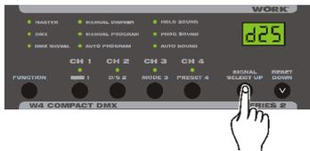
2. Pulse el boton Up/Down para ajustar la intensidad del canal.
