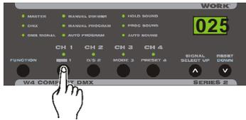
3. Una vez ha configurado la direccion DMX, pulse el boton de canal una segunda vez para almacenar su configuracion en memoria.
