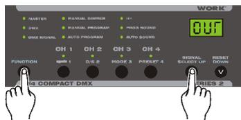
Mientras pulsa el boton F, Pulse la tecla de seleccion de señal, cuando el display muestre "OUT", el LED de Master se encendera indicando que el modo Master esta activo, esta unidad sirve como chaser de 4 canales DMX cuando la use conectandola a otras unidades.
