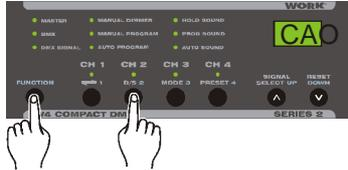
Mantenga presionado el boton F, pulse la tecla D/S para seleccionar el modo dimmer entre Cross y Normal.
