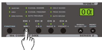
1. Pulse el boton de canal, el LED del canal correspondiente parpadeara indicando se seleccion y el display mostrara la ultima direccion DMX.
