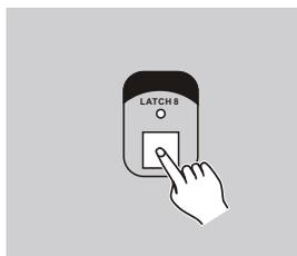
Si desea mantener encendido un canal del 5 al 8, presione la tecla Latch del canal que desea encender a pesar del programa de chase.
