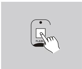
Cuando un programa de chase se está ejecutando, puede presionar los botones de Flash 1-4 para seleccionar los efectos Latch o Flash.
