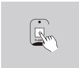
Si desea mantener un canal encendido, mantenga presionado el botón de Flash durante 2 segundos, el canal se encenderá a pesar del programa de chase. Pulse latecla Flash otravez para desbloquear el Latch.
