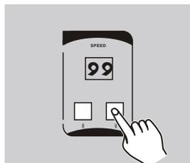
Presione los botones Speed UP/DOWN para seleccionar la velocidad de chase. 01 es la velocidad más lenta y 99 la más rápida, la pantalla muestra la velocidad actual.
