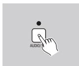
4. Pulse la tecla AUDIO/DEL, todos los LEDs parpadean 3 veces indicando que el paso ha sido borrado.
