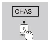
2. Presione y mantenga la tecla Record y a la vez los botones de Scene/Chase 1,6,8,1,6,8 en secuencia. El LED Record parpadea indicando que la grabación está habilitada y en pantalla aparece "CHAS" y las memorias grabadas se indicarán por el encendido de los LEDs.
