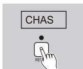
2. Presione y mantenga la tecla Record y a la vez los botones de Scene/Chase 1,6,8,1,6,8 en secuencia. El LED Record parpadea indicando que la grabación está habilitada y en pantalla aparece "CHAS" y los chases programados se indicarán por el encendido de los LEDs.
