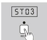
6. Pulse la tecla Record, todos los LEDs parpadean 3 veces indicando que ha cambiado el tiempo de fundido del paso.
