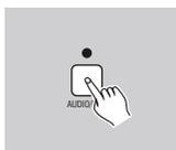
4. Pulse la tecla AUDIO/DEL, todos los LEDs parpadean 3 veces para indicar que el paso ha sido borrado.
